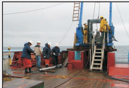
Deep Mini CPT / Drop Core Sampling at Sea
